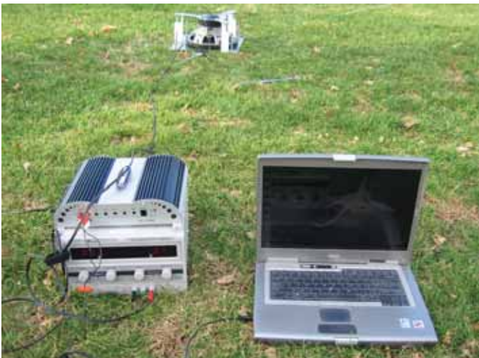
Figura 3. Transmisor y receptor del comunicador sísmico. Utilizando Data Acquisition Toolbox, la onda sísmica se transmite directamente a MATLAB para su análisis y visualización.
