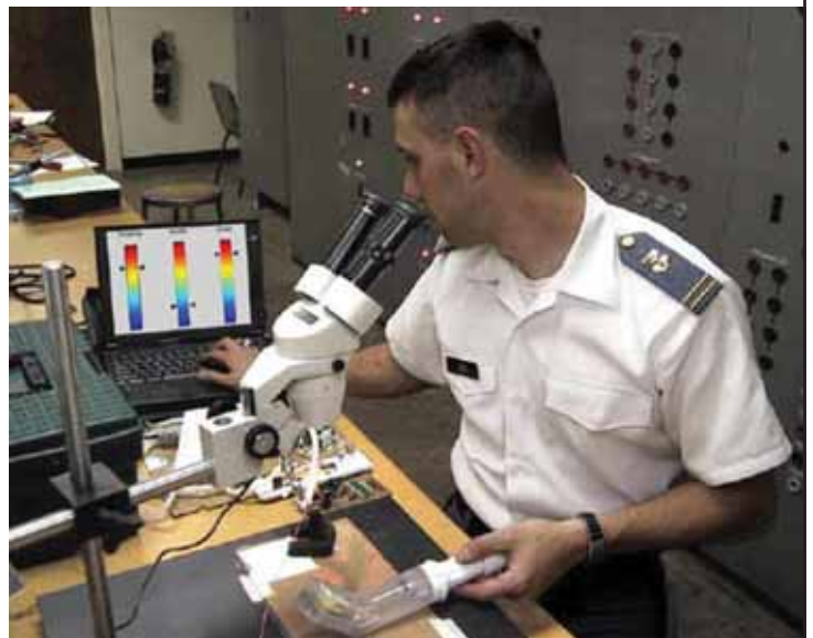
Figura 1. Un estudiante de ingeniería del VMI comprueba los sensores de presión en una cánula endovascular. Los datos de la presión se capturan utilizando Data Acquisition Toolbox y se muestran en una interfaz gráfica de usuario generada dinámicamente.
